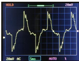
Abbildung 2 – Auftretende pulsierende Schwingung, 50 Hz Grundschiwingung überlagert mit WIFI Signal 2,4 GHz in einer Wohnung
